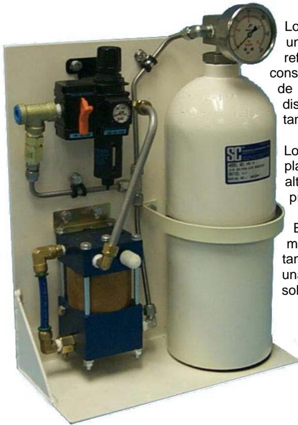
Los sistemas S10320-AB-2 y S10320-AB-4 son las unidades más compactas para aplicaciones de reforzamiento de presión de aire. Ambas unidades consisten en un reforzador de presión de relación de presión de 2:1 o 4:1, una combinación de filtro/regulador con un dispositivo de apagado, un manómetro de presión, y un tanque de 200 in<sup>3</sup> con un manómetro de alta presión.
