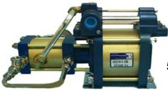
Todos los reforzadores de presión de SC Hydraulic son pre-lubricados en la fábrica y no deben ser usados con lubricadores de aire en línea. Es muy importante el uso de aire limpio y seco, ya que cualquier partícula, humedad, o materia extraña en el suministro de aire puede deteriorar los componentes de alta presión. Se recomienda instalar un filtro coalescente antes de la entrada de aire de suministro y accionamiento.
