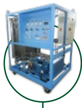
UNIDADES DE FLUSHING
